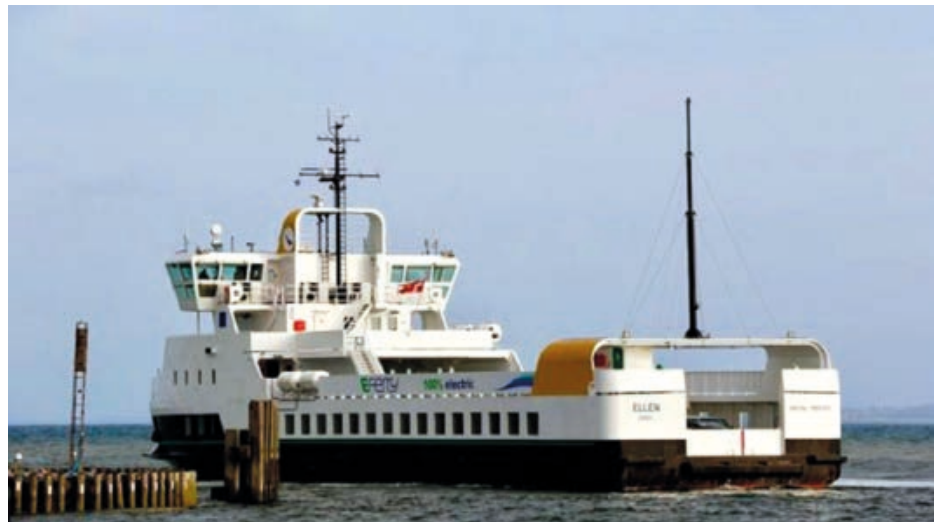
24.4 全球第一艘全電動渡輪——「安培號」 ( MV Ampere )。 MV Ampere , the world's first all-electric ferry.
