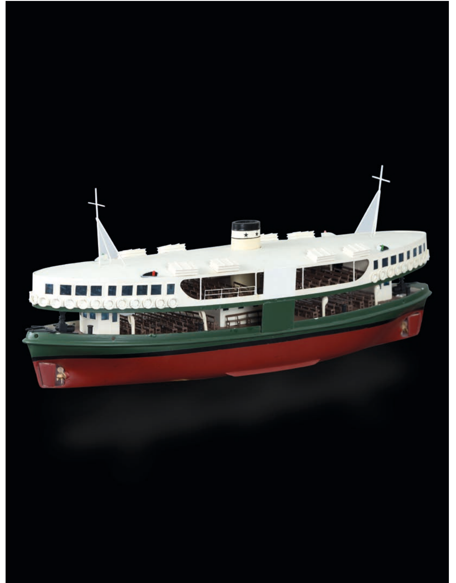
天星小輪模型，是黃埔船塢在1956年至1965年之間建造的11架柴油動力天星小輪之一。 Model of Star Ferry. One of the eleven diesel powered Star Ferries built by the Hongkong and Whampoa Dockyard Co. between 1956 and 1965. (HKMM2007.0113.0001)
